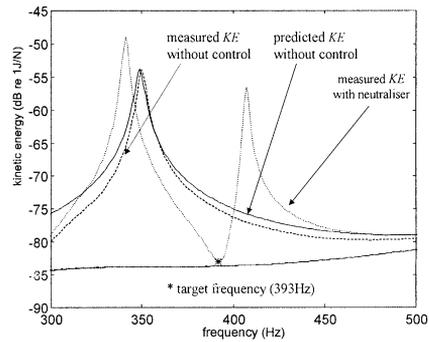
(d) Neutralizer no. 4 with  $\omega_a=395\text{Hz}$
